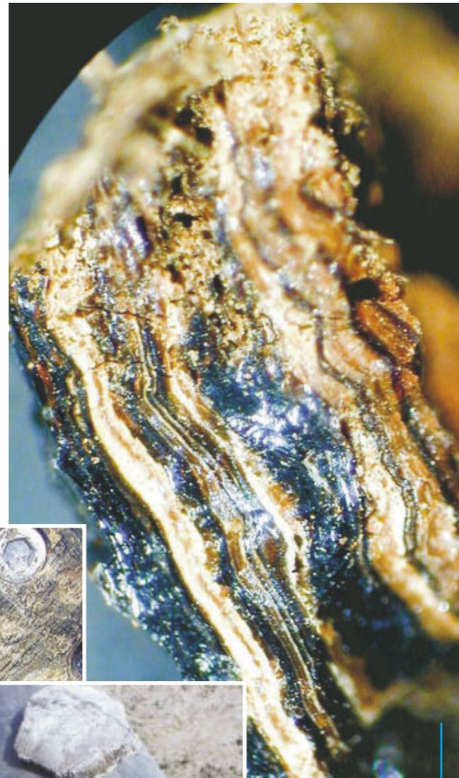
Вид слоев кристаллов под микроскопом (струвит) [\text{Mg}(\text{NH}_4)(\text{PO}_4) \cdot 6\text{H}_2\text{O}] .
