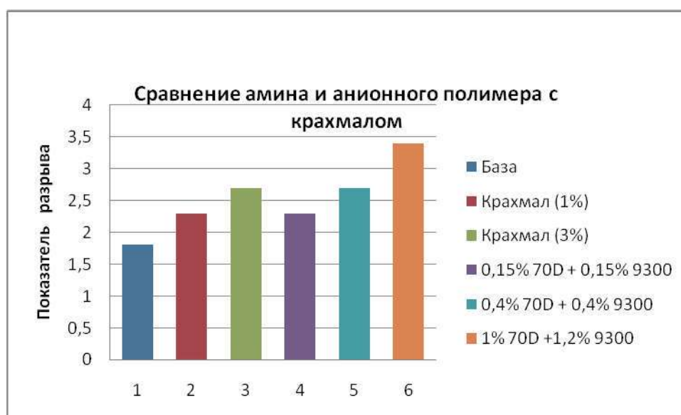
Рис. 2 Комбинация первичного амина и анионного полимера
